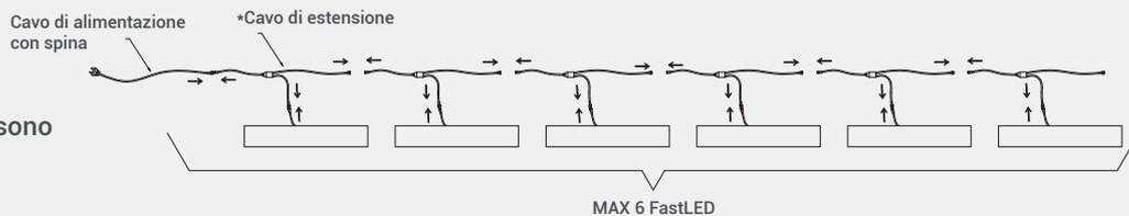
\*Per collegare 2 FastLED 2X1 sono necessari 2 cavi di estensione (codice FOL-LED-EXTCORD) fornito a parte.
